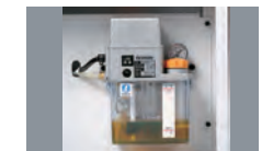
自動潤滑油装置 Automatic lubrication unit
